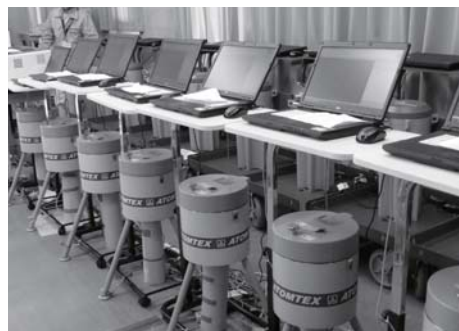
JA 福島県モニタリングセンターの簡易型分析器 (Nal シンチレーション検出器)
